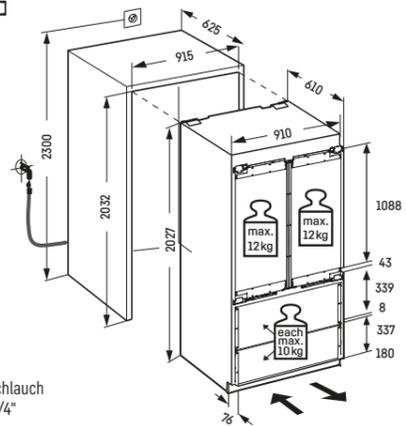
Inklusive 3 m Panzerflexschlauch für Festwasseranschluß 3/4"
